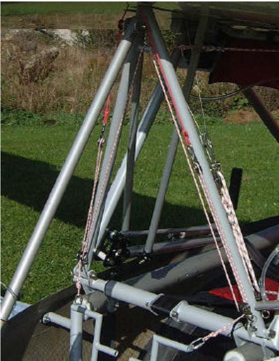
49. Connecter les câbles de palonniers. **Ne pas les intervertir** : le câble issu de l'aile gauche est branché sur le palonnier gauche.
