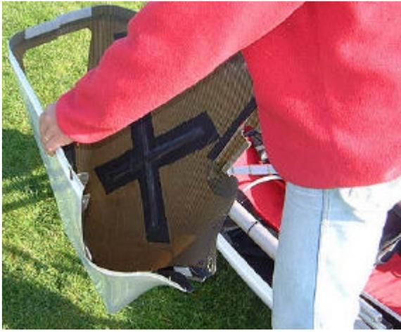
7. Pour maintenir la cellule en équilibre avant le montage des ailes, on peut se servir du cône de queue. Dans ce cas, assembler les 2 parties du cône de queue.
