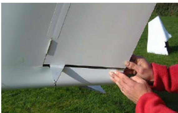
43. Fermer le velcro arrière vertical du karman en veillant à ce que les peaux soient parfaitement parallèles avec le volet de winglet.
