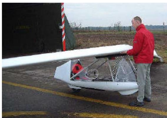
**Toujours supporter l'aile avec les mains bien à plat**, à l'intrados, à hauteur du longeron (le longeron est situé à l'endroit le plus épais du profil) ou aux extrémités de l'aile.
