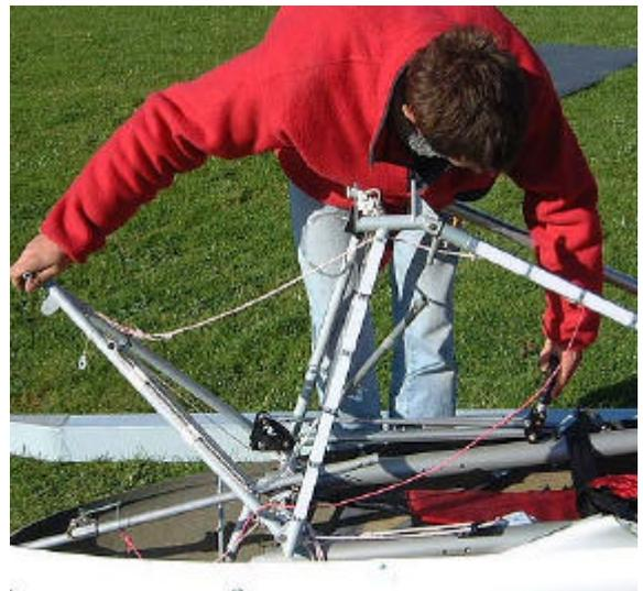
4. Engager l'axe arrière du manche dans son support en faisant basculer le cadre triangulaire vers l'avant.
