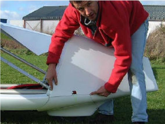
52. Présenter la partie gauche du cône de queue. Positionner d'abord l'angle arrière sur le puits de roue puis suivre le bord inférieur vers l'avant en engageant le velcro.
