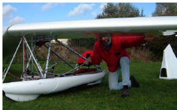
30. En tirant la commande des flaps presque à fond, retirer les axes retenant les bielles de flaps à l'intérieur de l'aile.
