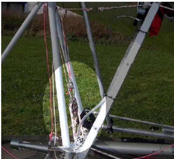
29. Connecter les câbles de flaps (volets) sur le mousqueton.
