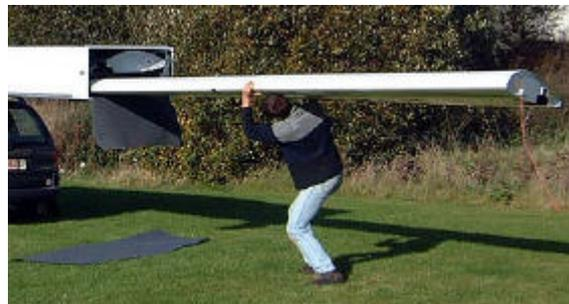
11. Préparer un tapis de protection sous le conteneur. Commencer en poussant l'**aile droite (inférieure)** par la nervure de bout d'aile (en carbone) pour dégager la dernière charnière d'élevon.
