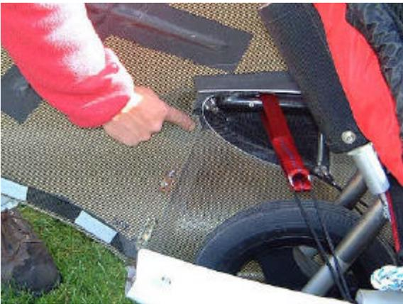
54. A partir de l'angle arrière, suivre le bord arrière du puits de roue vers le centre en engageant au fur et à mesure le velcro.
