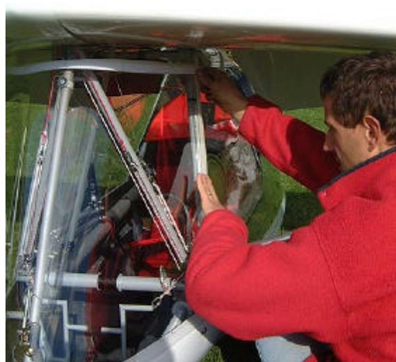
75. Progresser le long du tube vertical en pressant fermement le velcro.
