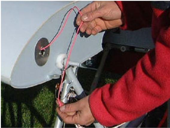
17. Aligner le 'doigt' du cadre triangulaire avec la bague en nylon fixée sur la nervure d'implanture, et engager l'aile complètement. Glisser le câble de contrôle de winglet dans la manille en inox.
