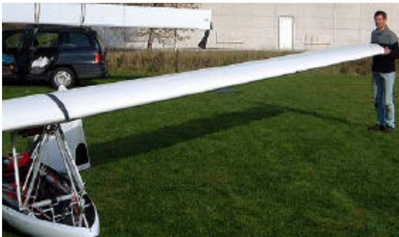
21. Quand l'aile est bien alignée, elle glisse facilement. Engager l'aile complètement. Si nécessaire, balancer légèrement l'aile pour introduire le doigt dans la bague en nylon.
