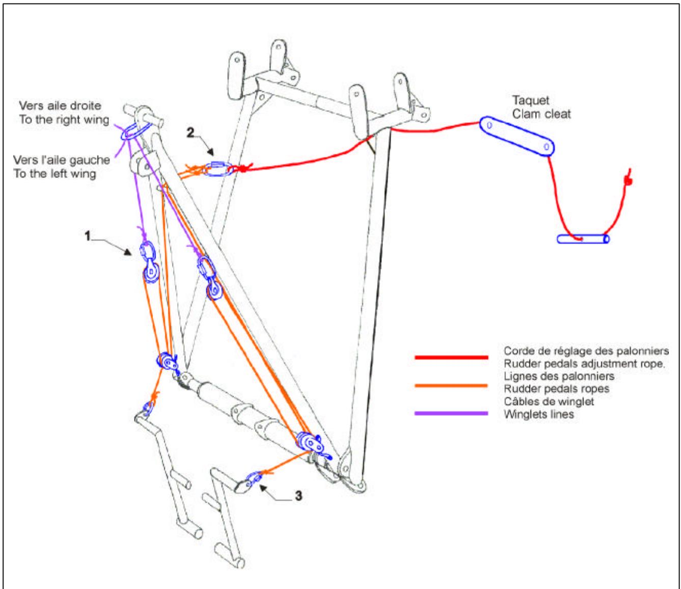
Au démontage, ne défaire que les maillons rapides '1'. Pour le repliage de la cage, la corde doit être libérée du taquet.
