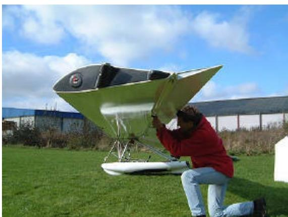
31. Connecter les élévons sur leur bielle avec un axe et un anneau de sécurité. Les élévons doivent être connectés avant de placer les winglets (dérives). Ne pas encore connecter les flaps.
