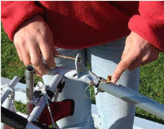
3. Bloquer l'assemblage avec les broches à billes (push-pins), la tête vers le haut, la boucle de la cordelette de sécurité orientée vers le bas pour éviter une interaction avec les ailes.
