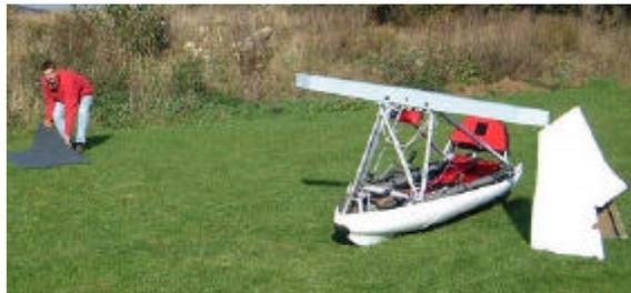
9. Stabiliser la cellule. On peut utiliser le cône de queue, ou le dispositif de fixation de la cellule sous le conteneur, ou un bâton en appui sous le longeronnet. Éviter de laisser la cellule basculer latéralement car cela endommagerait les flancs du carénage.
