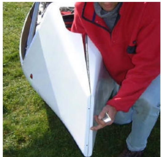
57. Mettre en place les pions à l'arrière du cône dans les ouvertures correspondantes puis assembler les demi-cône entre le puits de roue et l'arrière.
