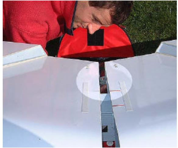
24. ... et faciliter ainsi la mise en place de l'axe arrière solidarissant les 2 ailes. **Mettre l'anneau de sécurité immédiatement.**
