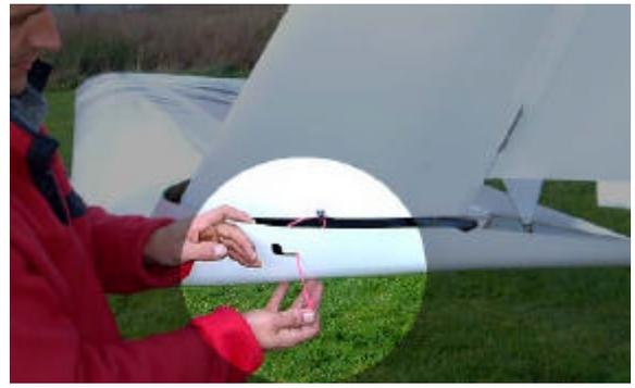
36. Présenter le karman de winglet. Passer le câble de commande à travers l'ouverture prévue.
