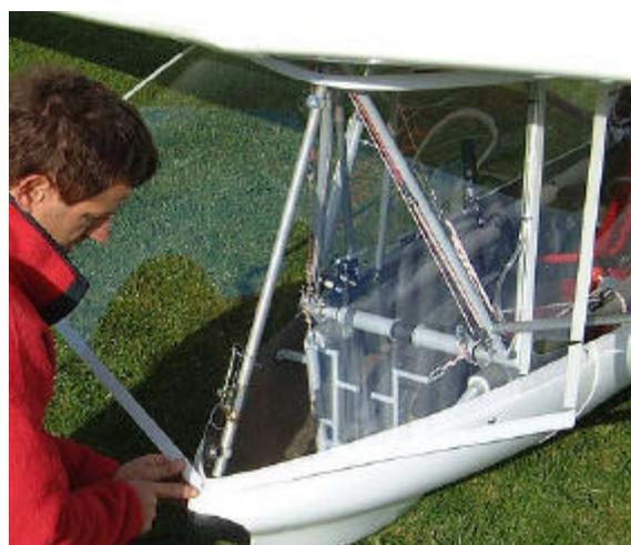
73. Positionner la pointe du pare-brise avant de commencer à engager les velcro.
