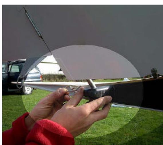
34. Placer la goupille bêta à travers la nervure en carbone et le tube arrière de winglet. La goupille doit ressortir de la nervure. Elle est inclinée vers l'aile et passe d'arrière vers l'avant.
