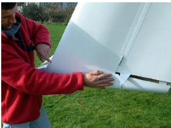
41. Aligner dans le plan vertical le bord extérieur supérieur du karman avec le velcro placé sous la charnière. Cela génère une tension qui va permettre au karman d'épouser parfaitement la forme du winglet. Engager le velcro.
