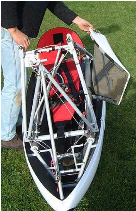
7. Avant de démonter la cellule, ranger les demi-cônes de queue sous le hamac.
