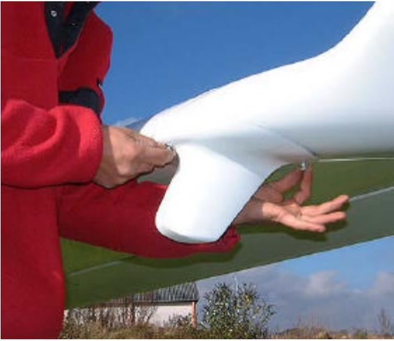
47. Placer le tiplet. Engager d'abord la vis arrière de quelques tours, puis mettre en place et visser à fond la vis de bord d'attaque. Serrer alors la vis arrière à fond.
