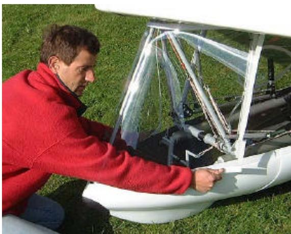
74. Tendre le pare-brise et engager les velcro en progressant le long du carénage.
