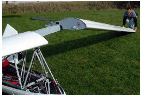
20. Saisir le bout d'aile et la faire glisser sur le longeronnet. **Veiller à ne pas forcer le fourreau du longeronnet** en alignant l'aile en hauteur, en flèche et en incidence.
