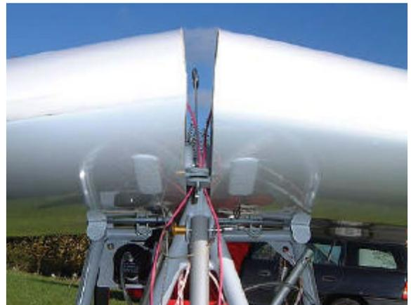
22. Placer l'axe solidarissant les 2 ailes à l'avant, et **mettre l'anneau de sécurité immédiatement**. Passer le deuxième câble de commande de winglet dans la manille.
