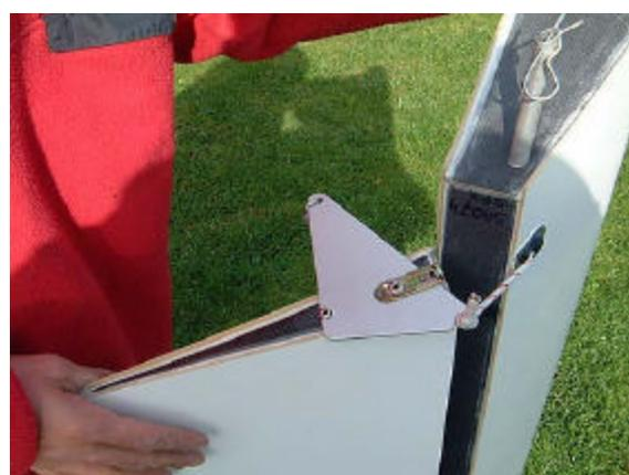
32. Monter le guignol de winglet sur son volet et engager l'élastique de rappel. Le nœud de l'élastique est orienté vers le haut du winglet
