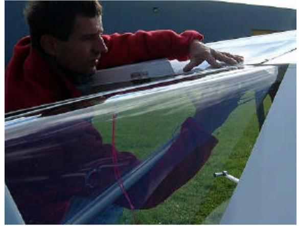
65. Mettre en place les rabats des vitres sur le bord de fuite des ailes de manière à ce que les vitres soient dans le prolongement de l'extrados.
