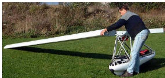
15. Déposer le bout d'aile sur le tapis de protection et saisir l'emplanture.
